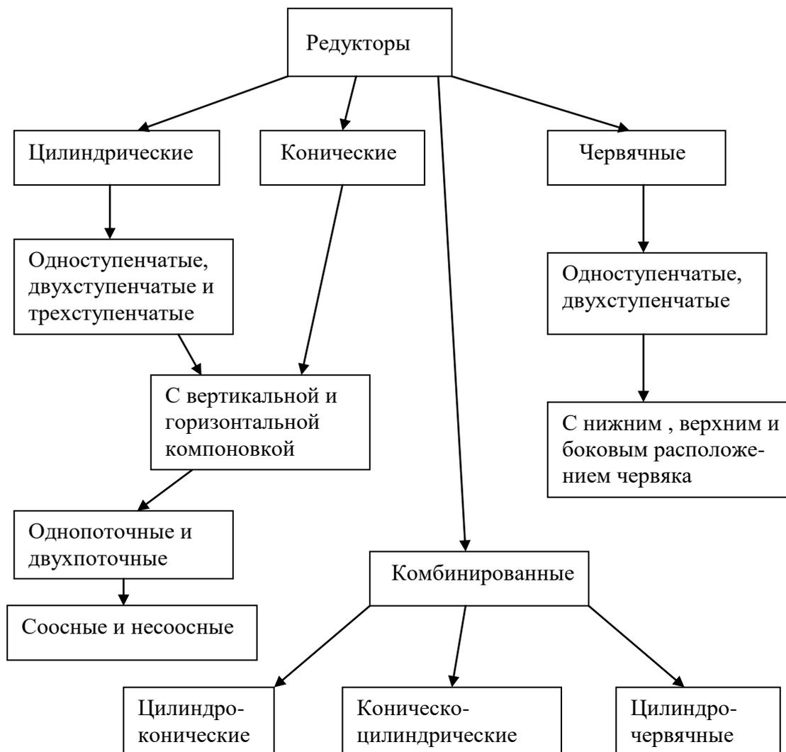
Рис.1.1. Классификация редукторов
