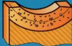
Червячные передачи с высокими антифрикционными свойствами (червячное колесо выполнено из оловянной бронзы). Выкрашивание связано с циклическим нагружением зубьев червячного колеса. Может быть ограниченным или прогрессирующим.
